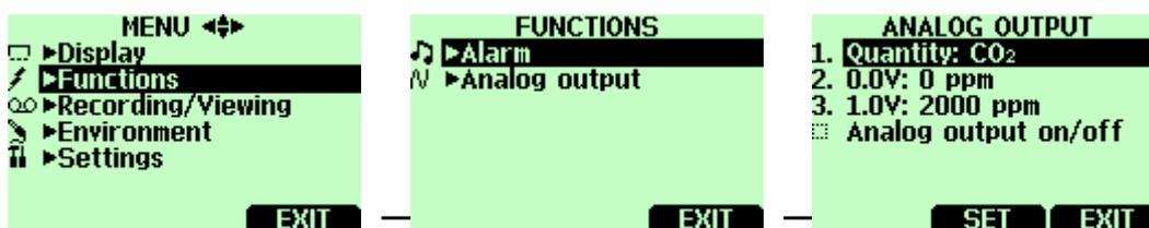
Для получения аналоговых данных измерений вам необходим сигнальный кабель аналогового выхода, см. Список принадлежностей на стр. 53. Возможен один канал по напряжению 0...1.0 В. Вы можете шкалировать выход для любого диапазона выхода, но рекомендуется шкала в пределах диапазона измерений измерителя для получения точных показаний.
