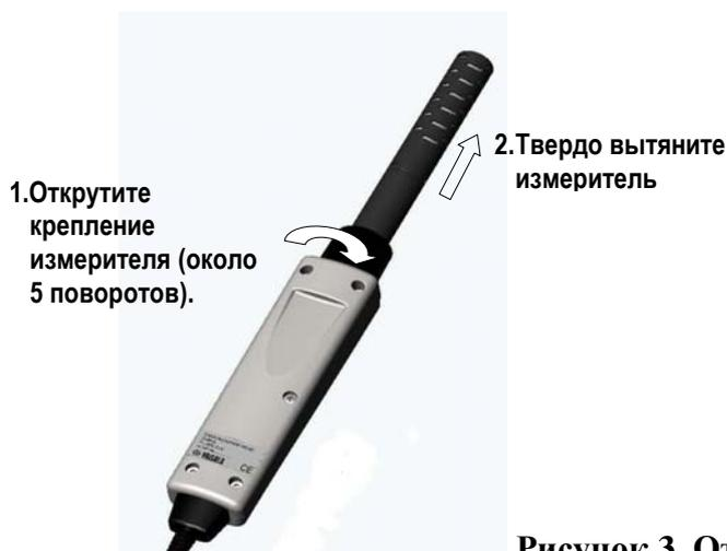
Рисунок 3. Открепление измерителя.
